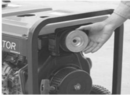
**Nota :** No ponga el motor en marcha sin el filtro de aire ya que algún objeto extraño podría introducirse en el motor y dañarlo. Cambie siempre el filtro de aire siguiendo lo establecido en el programa de mantenimiento.
