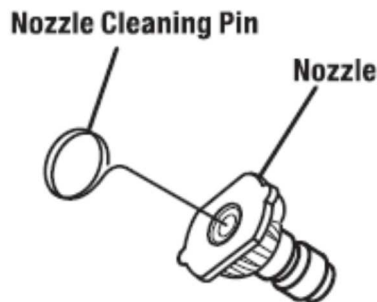
Nozzle cleaning pin – Anilla de limpieza de la boquilla nozzle – Boquilla
