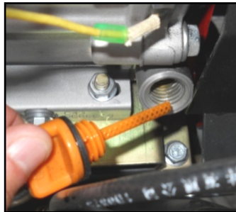
Figura 19: Varilla indicadora del nivel de aceite
