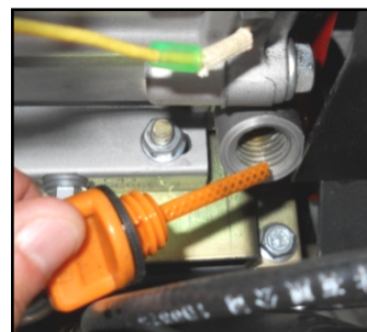
Figura 19: Vareta indicadora do nível de óleo
