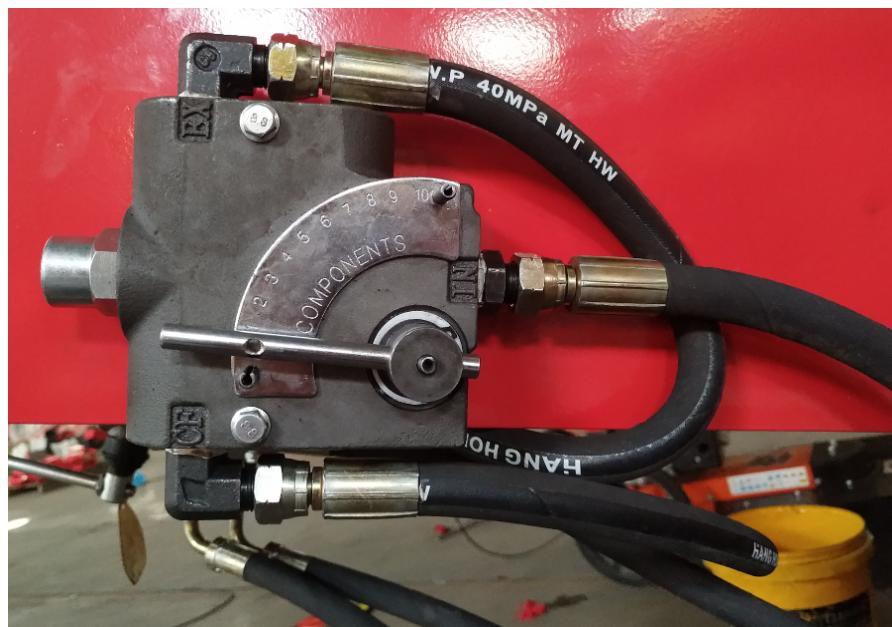
Com este manípulo pode ajustar a velocidade de rotação do rolo de alimentação (de 0-600rpm)
