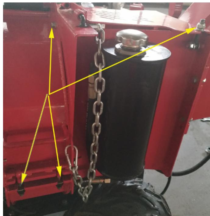
Ao soltar os 4 parafusos, você será capaz de abrir a câmara para verificar o estado das lâminas e ventiladores.
