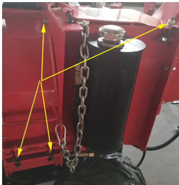
Al aflojar los 4 pernos, podrá abrir la cámara para comprobar el estado de las cuchillas y ventiladores.
