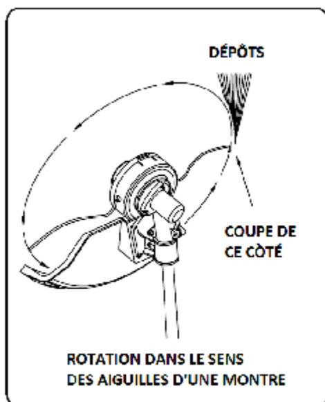
La lame de coupe de nylon est sur le côté gauche.
