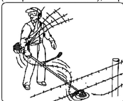
Siega de malas hierbas. Este corte se realiza desplazando la cuchilla en un arco. Rápidamente puede limpiar zona de malas hierbas o césped. La desbrozadora no se debe utilizar para cortar hierbas muy altas, duras o de tipo leñoso.
