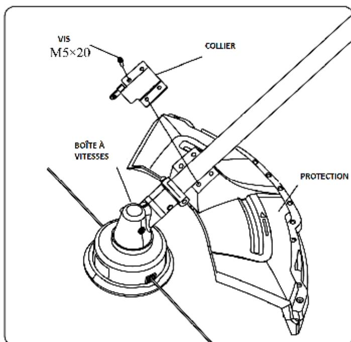
Placez le couvercle de sécurité dans l'axe avec les colliers et les vis qui y sont fournis.
