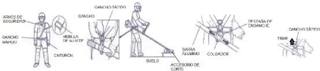
5. Pour fixer rapidement la débroussailleuse au harnais, tirez de la languette de fermeture rapidement vers le haut.
