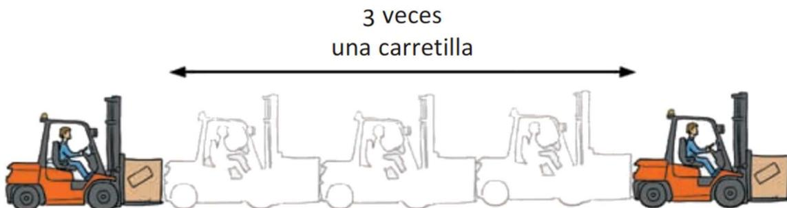
Respetar las normas de tráfico y de señalización del centro de trabajo. No adelantar a otros vehículos y procurar mantener una distancia de seguridad de tres veces la carretilla.
