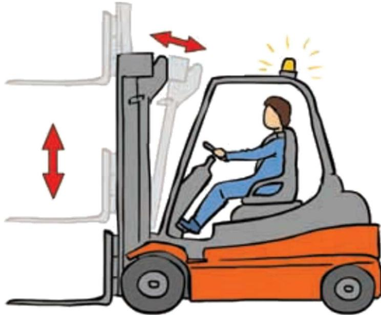
La inclinación del mástil y de las horquillas, así como verificar que se desplazan lentamente.
