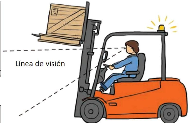
No desplazarse con la carga elevada ya que no puede existir un riesgo de vuelco o de golpes contra instalaciones, nunca circules con la carga encima de la línea de visión.
